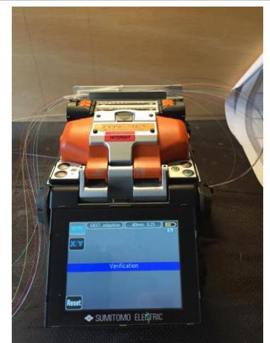
**Soudure des fibres**
